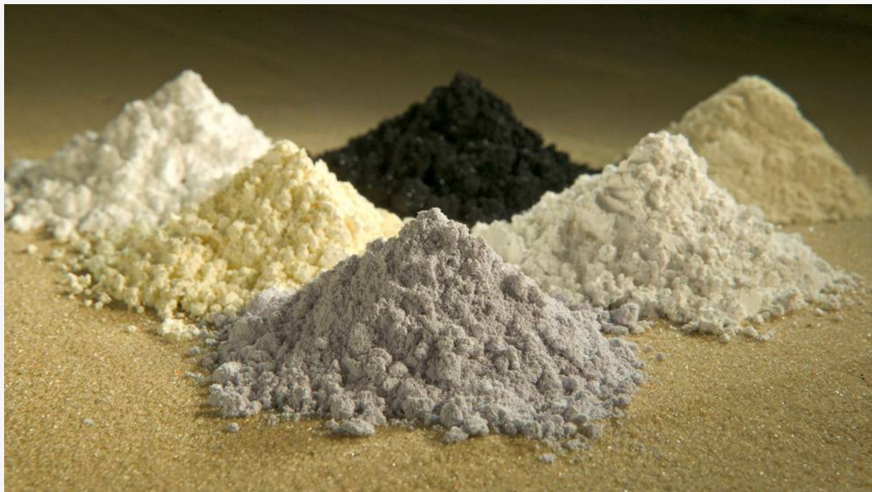
Fra den svarte haugen i midten, bak - og videre med klokken: Praseodym, Cerium, Lanthan, Neodym, Samarium og Gadolinium. FOTO: Peggy Greb/NTB Scanpix
